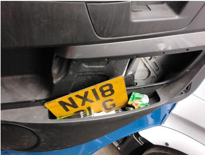
11: Door Pad osf Broken Replace
